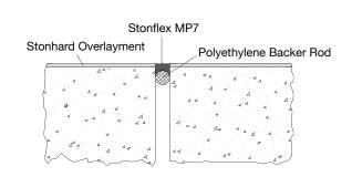
JOINT EXPANSION / ISOLATION JOINT DETAIL
